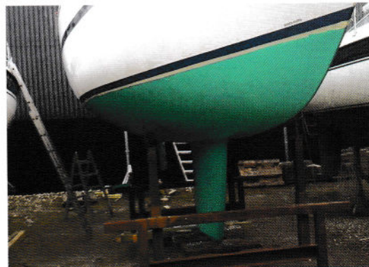
Epoxyprimer påføres efter en jævn slibning af bunden.
